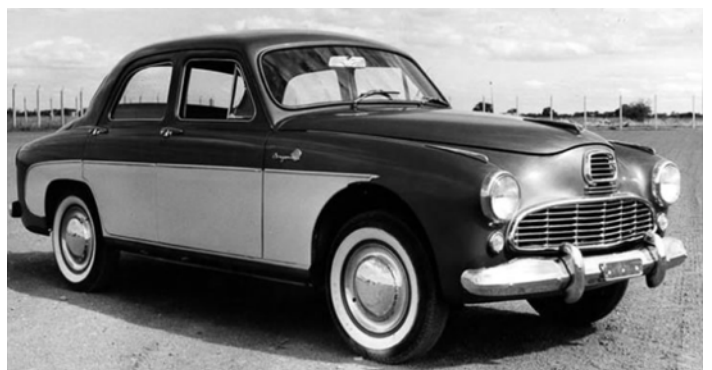
■ CI-DESSUS : Industrias Kaiser Argentina ou « IKA » acquit en 1959 d'Alfa Romeo l'outillage pour fabriquer la caisse de la 1900 Berlina, à laquelle ils adjoignirent une mécanique de Jeep. Baptisée IKA Bergantin, cette berlina fut fabriquée à 8 000 exemplaires. Une alliance avec American Motors en 1962 mit fin à la fabrication des anciens modèles. IKA fut éventuellement rachetée par Renault.
