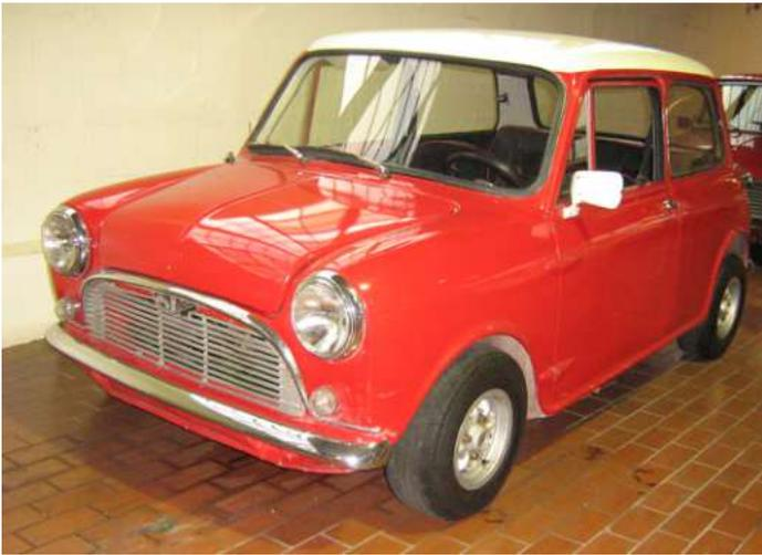
■ Une Mini fabriquée au Chili. Afin de respecter les règles fiscales, la carrosserie devait être fabriquée localement : BMC a choisi de la faire mouler en composite. L'absence de certains joints est un indice visuel. Quelques centaines de ces Mini furent fabriquées entre 1967 et 1975. Les moules servirent ensuite au Venezuela.
