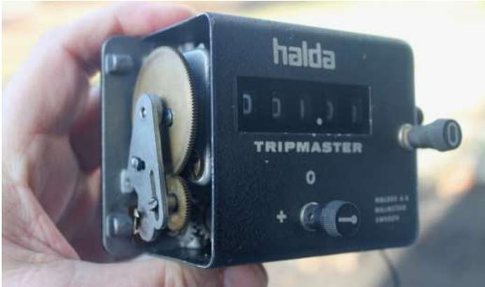
■ Un Halda Tripmaster montrant l'accès à ses engrenages de calibration.
