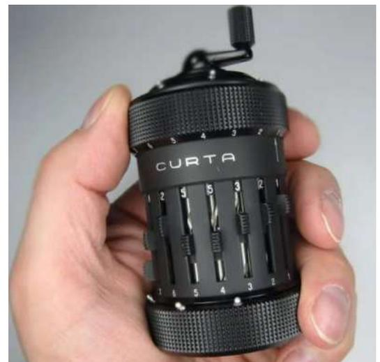
■ Calculateur mécanique Curta, ou « moulin à poivre », fréquemment employé par les navigateurs. Une version de poche du calculateur suédois Ohdner Arithmometer. Utile pour produire un tableau heure/position à partir de la vitesse moyenne imposée.
