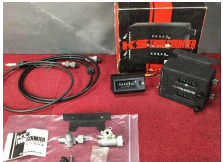
■ Deux odomètres japonais Kanto-Seiki. La version double fut employée sur les Datsun 240Z d'usine lors du East African Safari. Ces odomètres n'avaient pas la flexibilité de calibration offerte par les engrenages des odomètres Halda.
