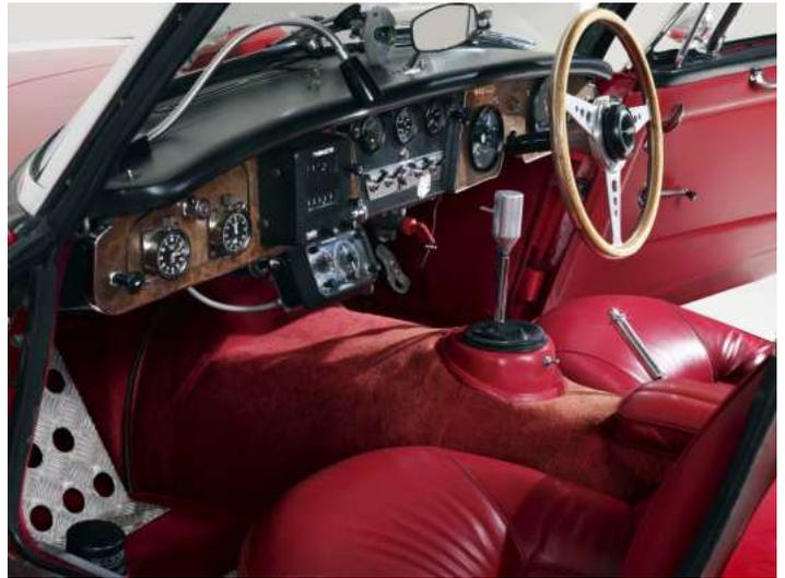
■ Une Austin-Healey 3000 aménagée pour le rallye. Le navigateur dispose d'un Twinmaster et d'un Speedpilot, d'un combiné horloge-chronomètre, d'une lampe de lecture et d'un repose-pied.
