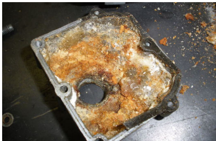
■ Dommages causés à un carburateur SU par la présence d'éthanol.
