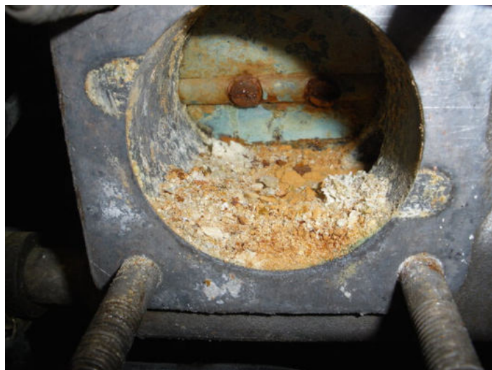
■ Dommages causés à un carburateur SU par la présence d'éthanol.
