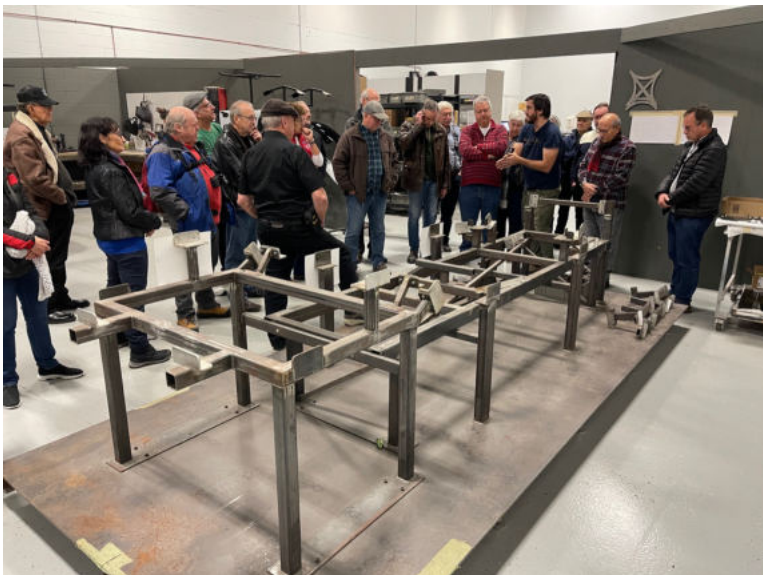
■ Le châssis naît sur ce gabarit.
