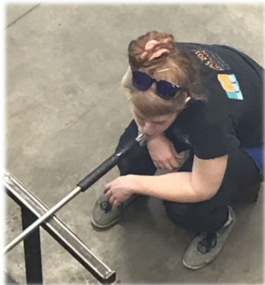
Figure 4 : Blowing into the hollow rod to form the base of the vase / Soufflage dans la tige creuse pour former la base du vase.
