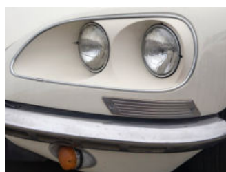
Citroën avait obtenu une dérogation de Transports Canada permettant la vente d'autos munies de phares à iode européens avec carénages. Mais l'usine du Quai de Javel nous a plutôt imposé les versions US pour écouler son inventaire d'entourages de phares moulés, dixit Claude Guillot.
