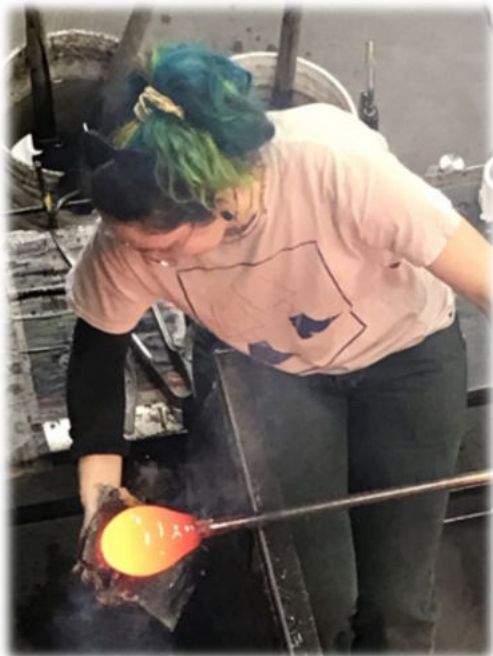
Figure 2 : Shaping with layers of wet newsprint / Façonnage avec des couches de papier journal humide.
