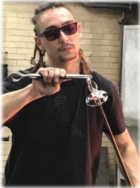
Figure 3 : Shaping the stem of a glass / Façonner le pied d'un verre
